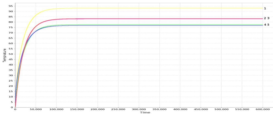
Рис. 7. График выхода на стационарный режим дна ADLE корпуса
